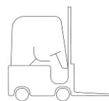
Die Produkte müssen mit einem Gabelstapler bewegt werden; man schiebt die Gabeln unter die Palette, um die Produkte anzuheben und sie an den Ort ihrer Installation zu bringen. Dabei ist darauf zu achten, dass die Last nicht aus dem Gleichgewicht gerät.
